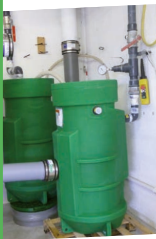
Base d'essais : vérification des performances d'un poste de relevage
