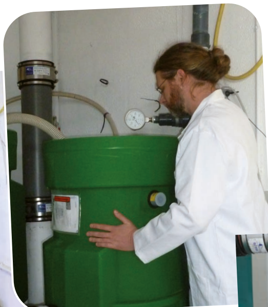
Base d'essais : vérification des performances d'un poste de relevage
