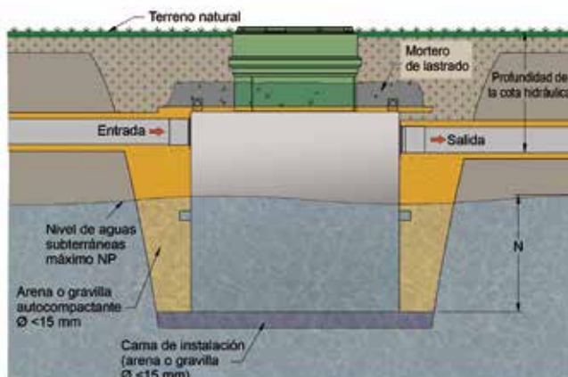
Instalación bajo espacios verdes
