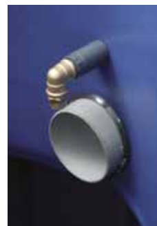
Detalle de la boquilla de pulverización para la entrada de féculas.
