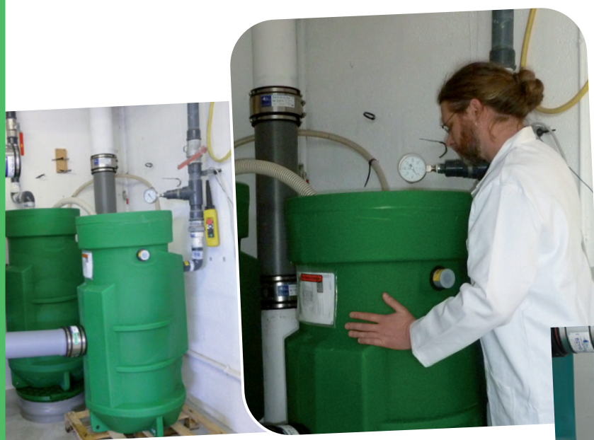
Base d'essais : vérification des performances d'un poste de relevage
