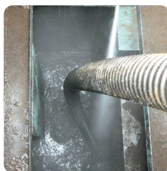
Nettoyage des parois par lance haute-pression
