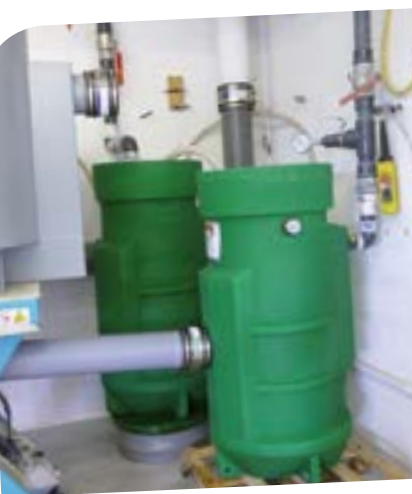
Base d'essais : vérification des performances d'un poste de relevage
