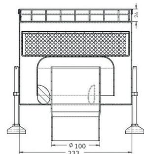
⚠ L'indication de résistance à 250 kN des grilles à barreaux ne s'applique pas aux chariots élévateurs munis de roues pleines et rigides dont la largeur est inférieure ou égale à 200 mm.
