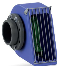
Le **caisson dégrilleur V2P20E** permet de bloquer les sacs plastiques et autres déchets ; l'entretien et l'ouverture sont aisés depuis le bord du bassin. Il se positionne par exemple à la sortie d'un bassin d'orage, avant le poste de relevage.
