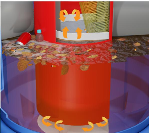
→ En caso de precipitaciones intensas, el DÉCANT'EAU, equipado con fosa de descarga, garantiza la gestión del caudal máximo.
