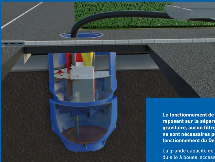
**Le fonctionnement de l'appareil reposant sur la séparation gravitaire, aucun filtre et substrat ne sont nécessaires pour le fonctionnement du Decant'eau.**
