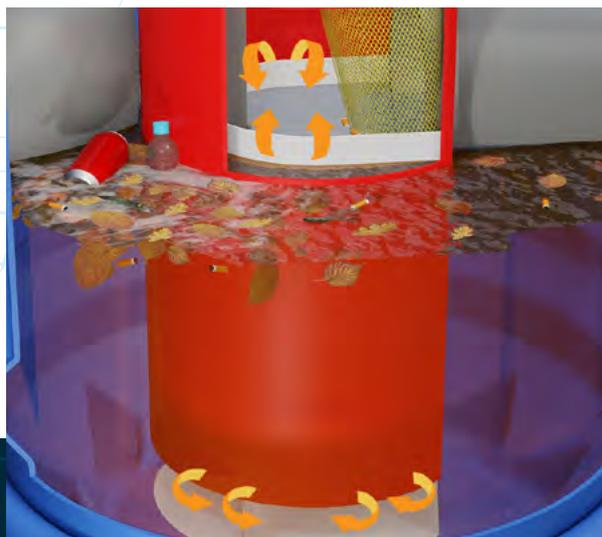
→ En cas de fortes précipitations, le **DÉCANT'EAU** équipé du puits de décharge assure la gestion du débit de pointe.
