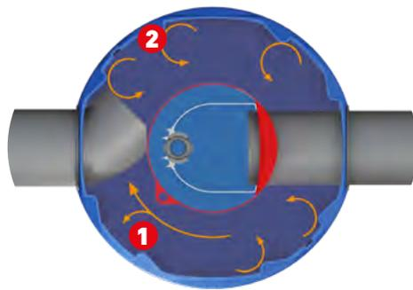
→ Le DECANT'EAU se compose d'une tête de répartition et d'un silo à boues. Cette géométrie, résultat de 36 mois de recherche et de développement, rassemble une multitude d'innovations et permet de piéger au maximum les M.E.S, tous diamètres confondus.
