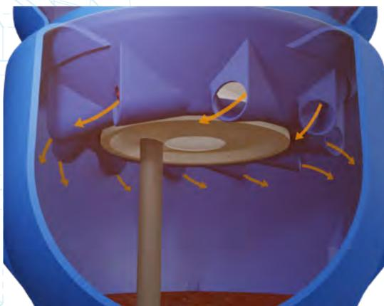
Un des nombreux atouts du Decant'eau est la répartition du flux en partie basse de la tête grâce au système de tuyères.
