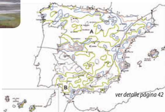
La intensidad pluviométrica se obtiene en la tabla de abajo en función de la isoyeta y de la zona pluviométrica de la localidad.
