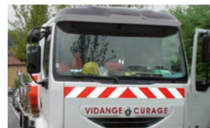
Hydrocureuse nécessaire à l'entretien de votre appareil avec colonne de vidange
