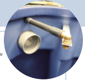
Détail de la buse d'arrosage interne au séparateur
