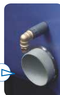
Detalle de la boquilla de pulverización para la entrada de féculas
